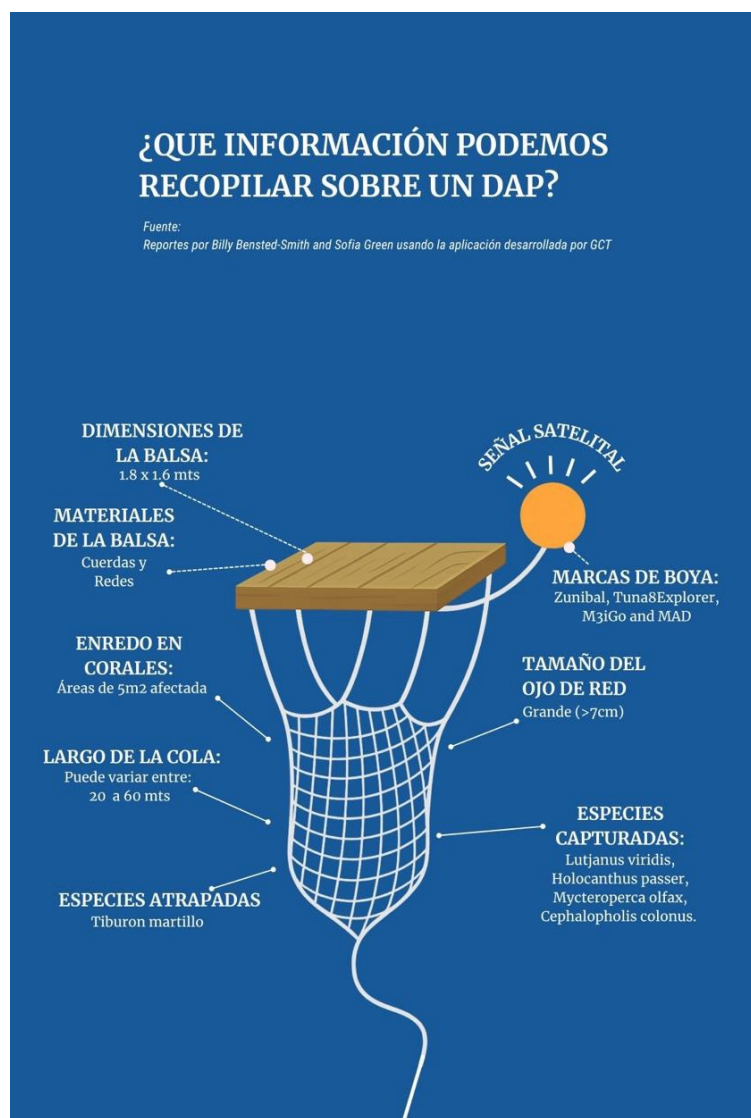
Figura 8. Esquema de las principales variables de un DAP, según el protocolo estandarizado de la DPNG (© GCT).
